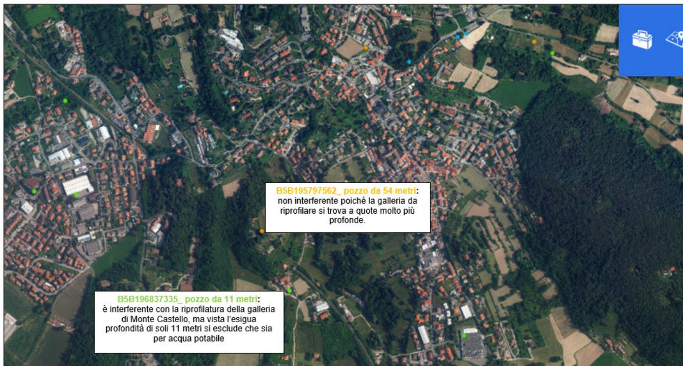
Figura 1 – Stralcio di ortofoto estratta dalla Banca Dati del Sottosuolo del Geoportale della Regione Lombardia. Con il colore arancio e verde sono indicati sia i pozzi che i sondaggi geognostici.
